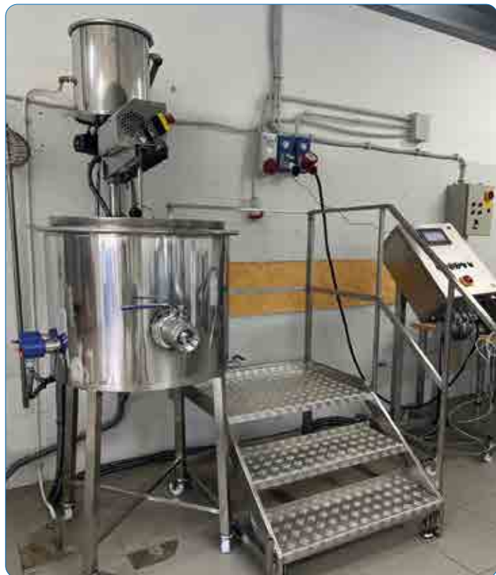
Gruppi MINICASEIFICIO a bagno d'acqua in acciaio INOX 304 con riscaldamento elettrico SERIE GR
