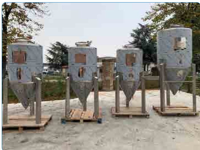
Fermentatori birra con raffreddamento centralizzato
